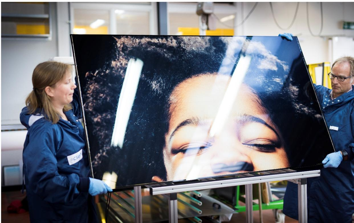
*L'image est imprimée sur un film qui a été spécialement sélectionné pour pouvoir s'intégrer de façon durable au module photovoltaïque.*
